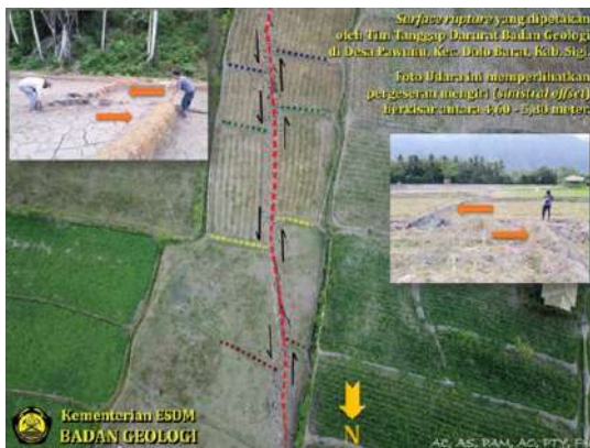
Gambar 3.11. Pergeseran mengiri ( sinistral offset ) sesar permukaan berkisar 4,6 m hingga 5,8 m akibat gempa bumi tanggal 28 September 2018 di Desa Pawunu, Kecamatan Dolo Barat, Kabupaten Sigi (Supartoyo drr., 2018).
