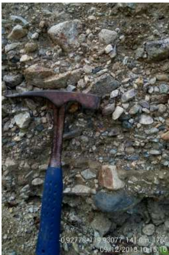
Gambar 4.3.22. Singkapan fasies Gcm bagian hulu area terdampak Petobo yang di analogikan setara dengan litologi pada kipas aluvial KPE (Sumber: Taufiq Wira Buana).
