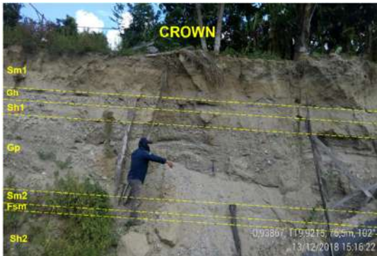
Gambar 1.7. Fasies pengendapan pada singkapan mahkota longsor di Petobo.
