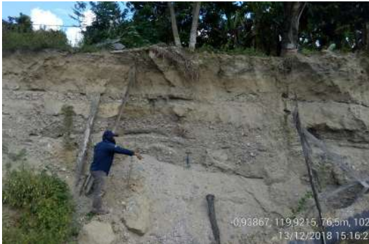
Gambar 4.3.20. Singkapan mahkota gerakan tanah Petobo yang menunjukkan perselingan lapisan kerikil - kerakal (produk sediment gravity flow ) dan pasir (produk sand bedforms ) (Sumber: Buana, 2018).
