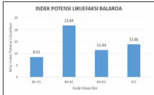
Gambar 4.3.13. Indeks potensi likuefaksi pada lokasi BH-01, BH-02, BH-03, dan B-5 di Balaroa.
