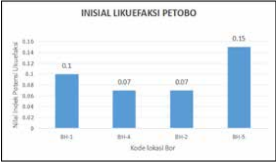
Gambar 4.3.27. Inisial likuefaksi pada lokasi BH-1, BH-4, BH-2, dan BH-5 di Petobo.
