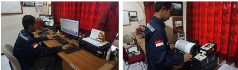
Foto 2. Sistem pemantauan seismik di Pos PGA Gede, data digital yang ditransmit dari setiap stasiun seismik direkam dan ditampilkan melalui layar monitor PC (a), sedangkan rekaman analognya juga dapat ditampilkan melalui drum rekorder PS-2, yang menampilkan data seismik dari Stasiun Gunung Putri (PUT) (b).
