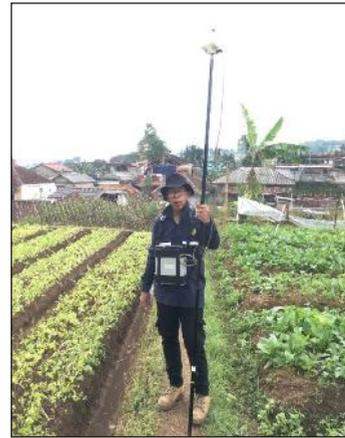
Gambar 3. Pengukuran data magnet di stasiun lapangan menggunakan Magnetometer Conselo GSM 19T
