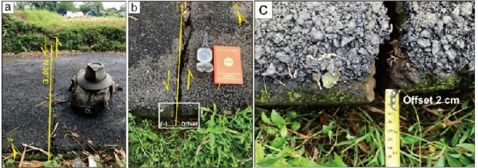
Gambar 21. Retakan permukaan di Kampung Longkewang, Desa Gasol, Kecamatan Cugenang. (a) retakan permukaan dengan arah N300E, retakan ini memotong jalan aspal dan memperlihatkan arah gerak mengiri atau sinistral. (b) dan (c) gambar yang memperlihatkan pergeseran lateral/offset yang memperlihatkan pergeseran lateral/offset sebesar 2 cm.
