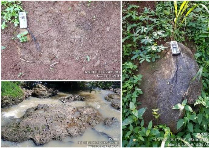
Gambar 7. Litologi di kawasan calon lokasi relokasi merupakan kontak antara tanah (A), Frahmen Lava (B) dan breksi (C) pada bagian bawahnya.
