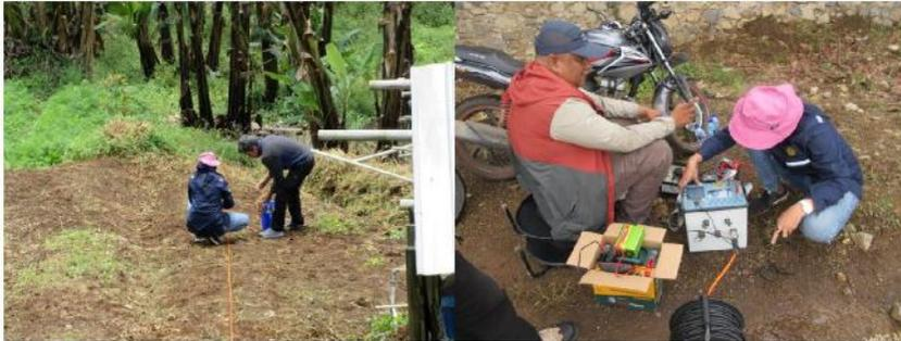
Gambar 34. Proses pengambilan data bawah permukaan menggunakan alat geolistrik.
