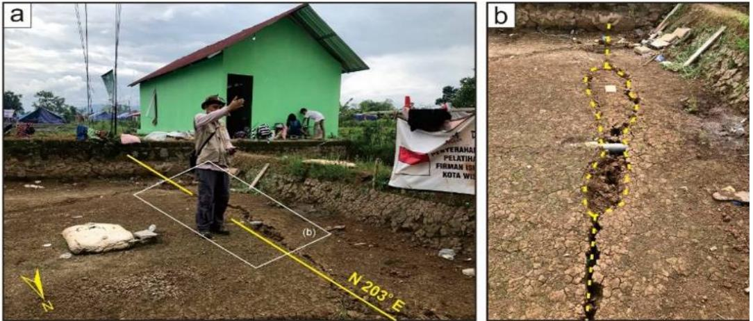
Gambar 27. Retakan permukaan akibat sistem tarikan (extensional stress) di Desa Cibulakan.
