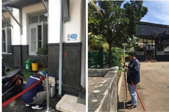
Gambar 1. Pengikatan Pengukuran posisi dan Ketinggian titik TTG 61 di depan Stasiun Kereta api Cianjur menggunakan GPS Leica dan pengikatan G Obs menggunakan Gravitimeter G.525.
