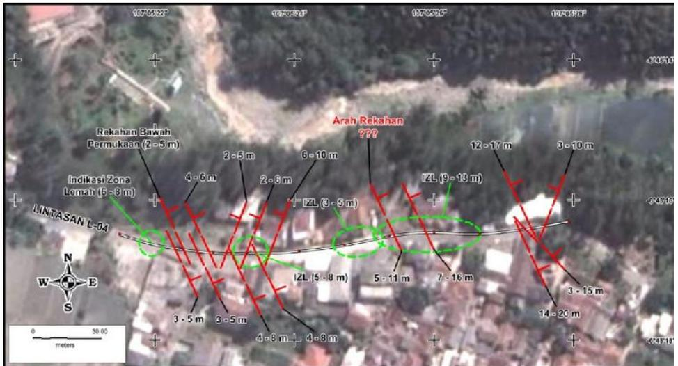
Gambar 11. Pengambilan data GPR di Lintasan Desa Gasol
