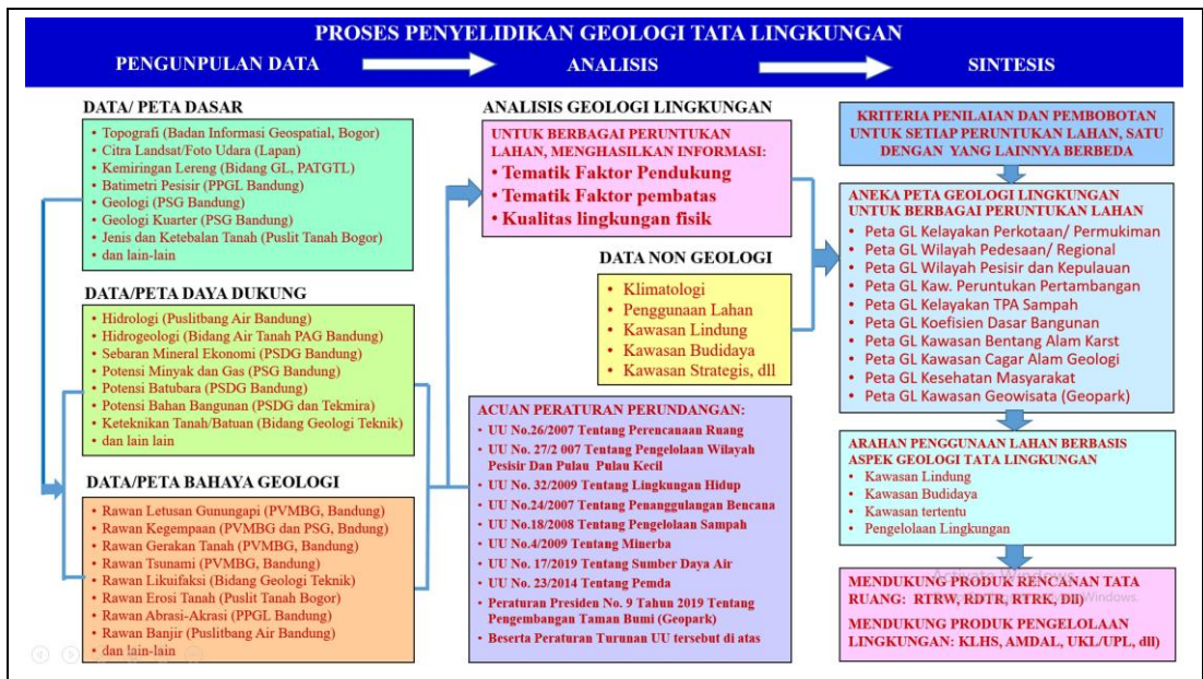
Gambar 5.3. Proses Penyelidikan Geologi Tata Lingkungan dari Pengumpulan Data hingga Sintesis Rekomendasi. Bagan menunjukkan bahwa penyelidikan GTL dimulai dari pengumpulan data/peta dasar, data/peta daya dukung, dan data/peta bahaya geologi. Data tersebut kemudian dianalisis bersama data non-geologi dan acuan peraturan perundang-undangan untuk menghasilkan informasi tematik mengenai faktor pendukung, faktor pembatas, dan kualitas lingkungan fisik. Hasil analisis selanjutnya disintesis menjadi berbagai peta geologi lingkungan untuk peruntukan lahan tertentu, arahan penggunaan lahan berbasis aspek geologi tata lingkungan, serta dukungan terhadap produk rencana tata ruang dan dokumen pengelolaan lingkungan.
