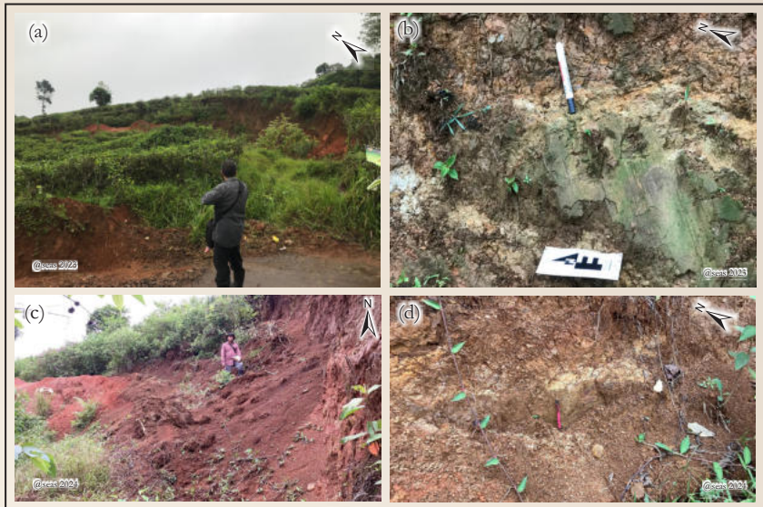
Gambar 6.8 Singkapan batupasir tufan bagian dari Formasi Besar di daerah Nyalindung, Kabupaten Sukabumi. (a) mahkota longsor, (b) jejak sesar di mahkota longsor (Foto: Sukahar Eka A. Saputra, 2023). (c) dan (d) longsor di tempat yang sama, pada zona sesar Segmen Nyalindung (Foto: Sukahar Eka A. Saputra, 2023, 2024).
