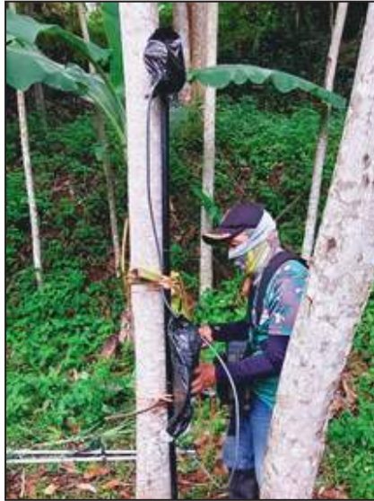
Gambar 7.9 Pengaturan magnetometer base dengan alat GEM GSM-19T .
