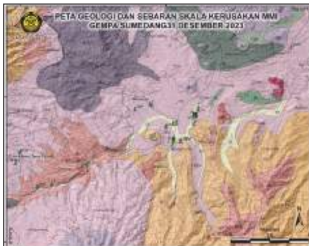
Gambar 5.5 Peta geologi atau sebaran batuan daerah Kota Sumedang dan sekitarnya dengan sebaran lokasi kerusakan berdasarkan skala MMI akibat gempa 31 Desember 2023 (Peta dasar dari peta geologi skala 1:100.000, lembar Bandung terbitan Puslitbang Geologi, pemeta Silitonga, P.H., 2003).
