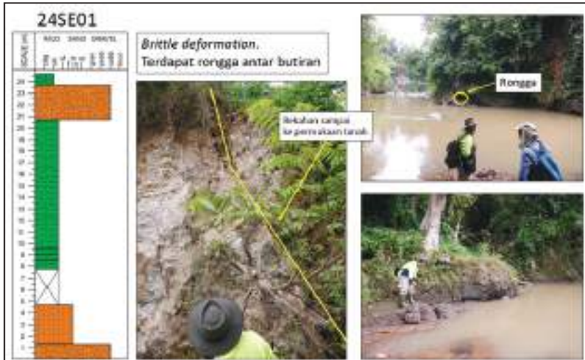
Gambar 5.9 Foto singkapan dan stratigrafi terukur dari stasiun 24SE-01 memperlihatkan adanya rekahan di singkapan menerus sampai ke permukaan tanah, pada singkapan tersebut terdapat rongga antar butiran sebagai bukti adanya Brittle deformation . Pengukuran stratigrafi dan foto oleh Dzul Fadli (Badan Geologi, 2024).
