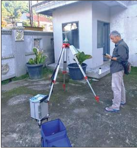
Gambar 7.3 Setting DGPS base dan pengukuran titik awal gaya berat menggunakan gravimeter.
