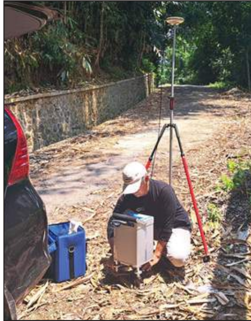
Gambar 7.4 Pengukuran gaya berat field dengan gravimeter dan ketinggian dengan DGPS rover pada titik pengukuran di lapangan.
