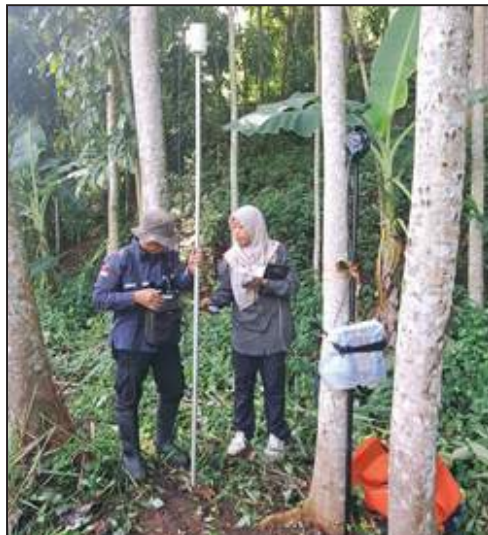
Gambar 7.10 Persiapan pengukuran instrumen magnetometer G-856 yang digunakan sebagai rover pada titik base sebagai pengunci awal dan akhir pengukuran geomagnetik.
