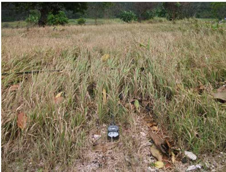
Gambar 12.11. Rebahan rumput untuk mengukur arah datangnya tsunami. Lokasi pantai Carita dan arah datangnya tsunami N 110°E.
