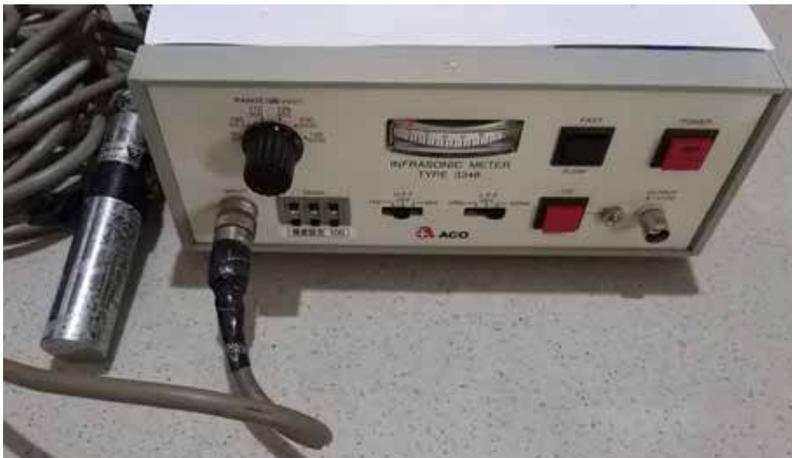
Gambar 15.34. Peralatan mikrofon (ACO, tipe 7144) dan amplifier (tipe 3348) yang digunakan untuk memantau aktivitas letusan GAK.
