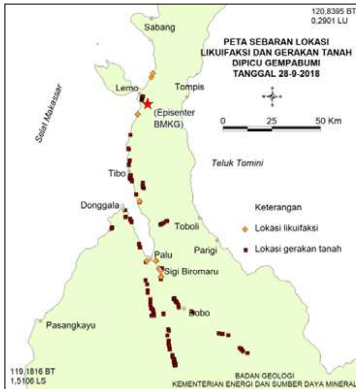
Gambar 3.25. Peta sebaran lokasi likuefaksi dan gerakan tanah dipicu kejadian gempa bumi tanggal 28-9-2018.
