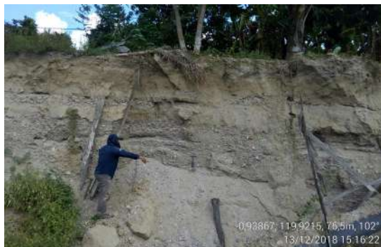
Gambar 4.3.20. Singkapan mahkota gerakan tanah Petobo yang menunjukkan perselingan lapisan kerikil - kerakal (produk sediment gravity flow ) dan pasir (produk sand bedforms ) (Sumber: Buana, 2018).
