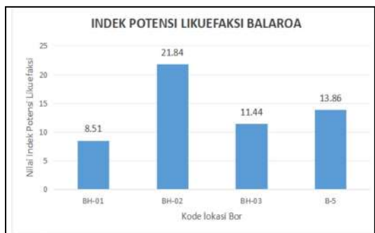
Gambar 4.3.14. Inisial likuefaksi pada lokasi BH-01, BH-02, BH-03, dan B-5 di Balaroa.
