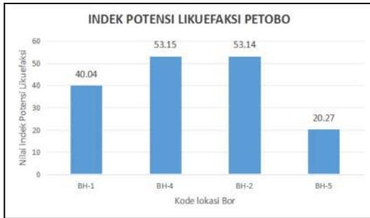
Gambar 4.3.26. Indeks potensi likuefaksi pada lokasi BH-1, BH-4, BH-2, dan BH-5 di Petobo.
